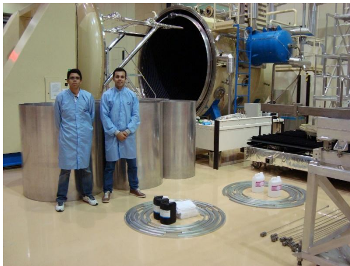
Figura 3.1 - Cilindros e flanges em frente à câmara de vácuo-térmica de 3x3 m.
