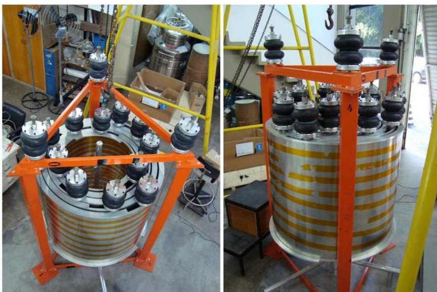
Figura 2.7 - Multi-Nested Pendula (MNP) montado no Laboratório de Ondas Gravitacionais Dr. Sérgio Ricardo Furtado. À esquerda, vista superior; à direita, vista lateral.
